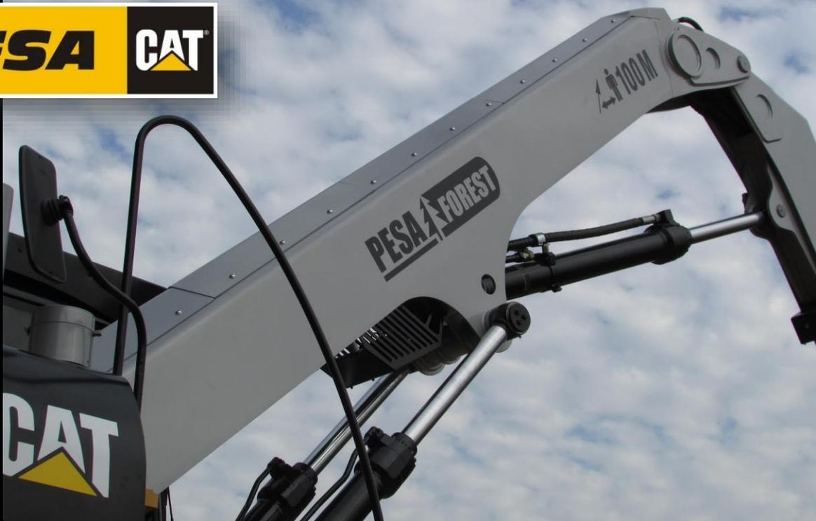
**Definição:** *PESA TRACKER HARVESTER PTH-18* é uma máquina projetada para atender o Mercado Florestal, possui um cabeçote que processa as árvores individualmente, ou seja, cada árvore é derrubada, desgalhada, destopada e traçada separadamente.
