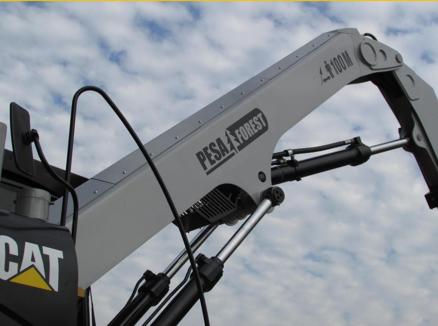
Na análise do ciclo operacional do Harvester **PTH-18**, locamos o **CILINDRO STICK** na posição inferior da lança, para um maior desempenho e proteção. O processo exige força na operação de manipular a árvore, e as atividades consideradas na dinâmica deste trabalho foram: deslocamento da máquina, posicionamento do cabeçote para corte, tempo de direcionamento do cabeçote para iniciar o corte de abate da árvore, corte de derrubada, acionamento do sabre e tombamento da árvore.
