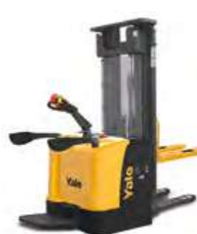
MS15XUX OPERADOR EMBARCADO 24V 1500KG
