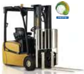
ERP15-20VT PNEUMÁTICA/ELÁSTICA 48V 1.500 - 2.000 KG
