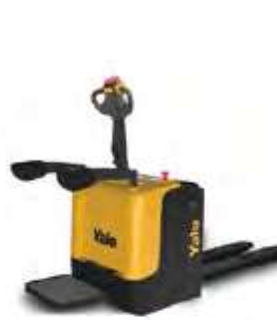
MP20XUX OPERADOR EMBARCADO 24V 2.000 KG
