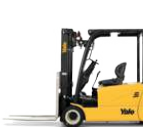
ERP16-20UXT PNEUMÁTICA/ELÁSTICA 48V 1.600 - 2.000 KG
