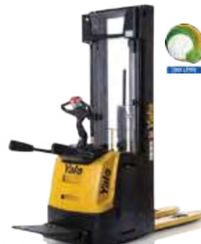
MS12-20X OPERADOR EMBARCADO 24V 1.200 - 2.000 KG
